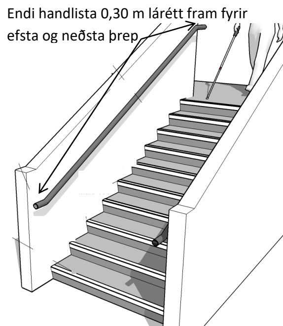
Mynd 4. Endi handlista fram fyrir efsta og neðsta þrep
